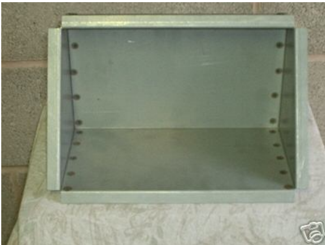
La boîte à air qu'il faut intégrer sur l'auto après découpe à la scie pneumatique
