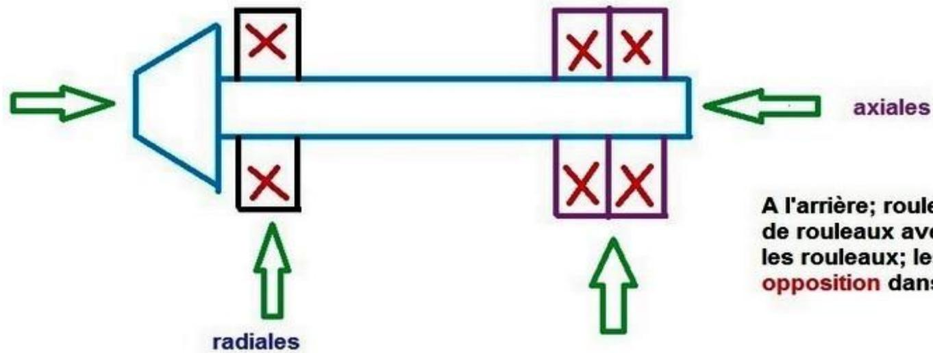
A l'avant; roulement à rouleaux cylindriques jointifs; (sans cage).
