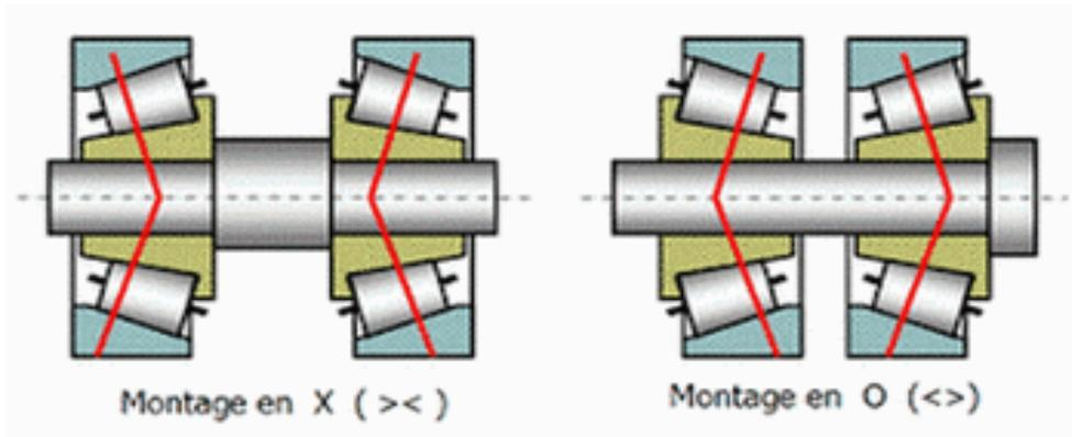
Angle de portée des roulements à rouleaux coniques. ( $\alpha_f$ )
