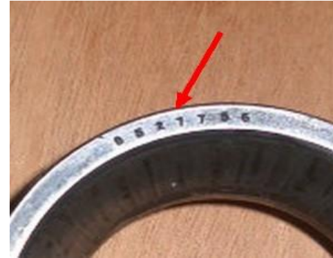
Ancienne construction, flèche rouge, référence Renault gravée sur la cuvette. Référence 8527756.
