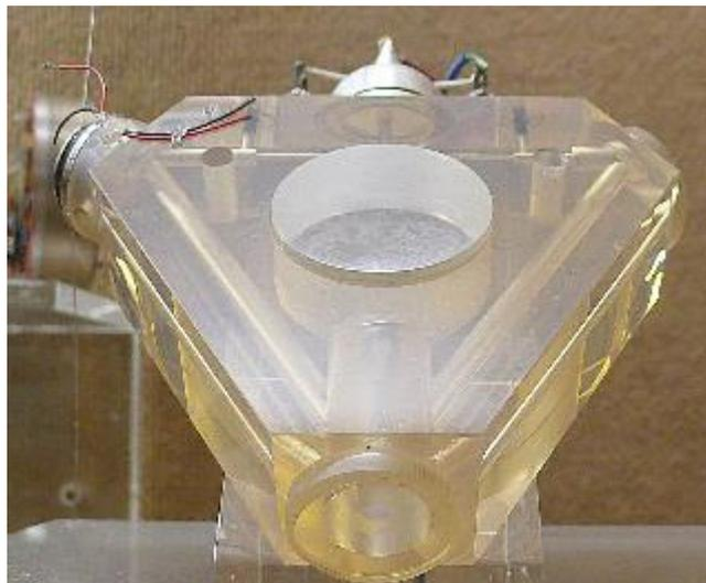
« Un **gyromètre laser** ou **gyrolaser** est un capteur de [vitesse angulaire](#) ([gyromètre](#)) mettant en œuvre un rayon [laser](#). Celui-ci parcourt un circuit optique dans les deux sens, l'[interférence](#) des deux rayons observée traduit la vitesse de rotation de l'ensemble. »
