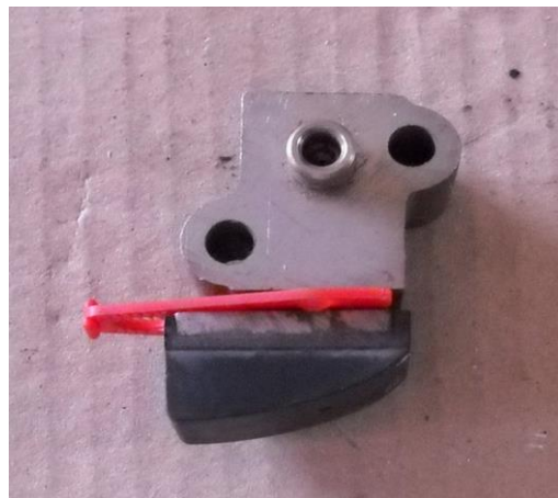
Tendeur hydraulique BRAMPTON RENOLD réf 7700719076 pour chaîne simple.
