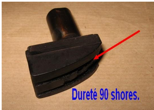
Tendeur neuf R15TS; R16; R17; R12G; A310 4 cylindres. Dureté du patin neuf 70 à 75 shores.
