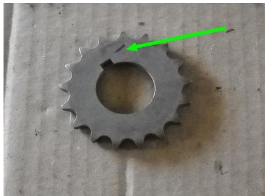
Disque de vilebrequin 17 dents pas 3/8" = 9,52 mm module 6B (flèche rouge) chanfrein montage coté vilebrequin (flèche verte) repère de calage. Référence = 7701349043.
