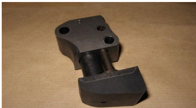
Tendeur neuf R15TS; R16; R17; R12G; A310 4 cylindres. Dureté du patin neuf 70 à 75 shores.
