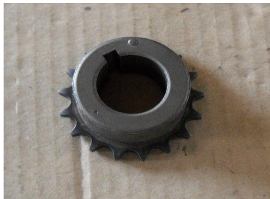
Pignon de vilebrequin 17 dents mêmes caractéristiques que le disque ci-dessus
